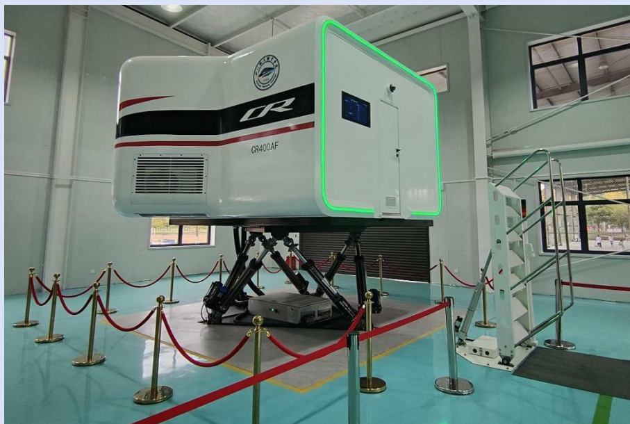
图 3—1 模拟驾驶考评设备——CR400AF 六自由度全功能模拟驾驶器
